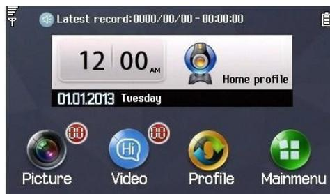
Внутренний монитор может показать наружное изображение и записывать фотографии, когда посетитель нажимает кнопку дверного звонка. Нажмите «Переключение режима» для переключения «Домашний профиль», «Msg-профиль» или «Телефонный профиль».
