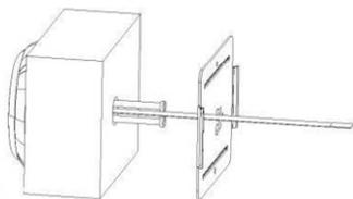
Пропустите кабель FPC через прямоугольное отверстие. (Примечание: Тонкий прямоугольный вырез на металлической пластине должен быть направлен вправо, а крупнейшая секция пластины с голым металлом должна быть на левой стороне от глазка.)
