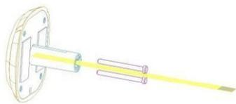
Выберите длину крепежного винта на основе толщины двери. Затем вверните его в отверстие для винта.
